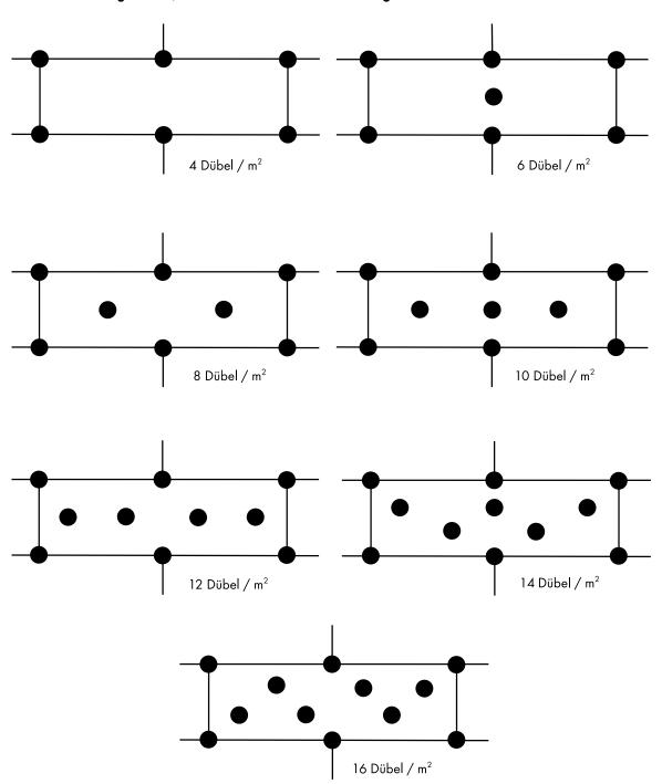
Ungerade Dübelmengen werden als Kombination der nächst liegenden geraden Dübelmengen im Wechsel dargestellt.
